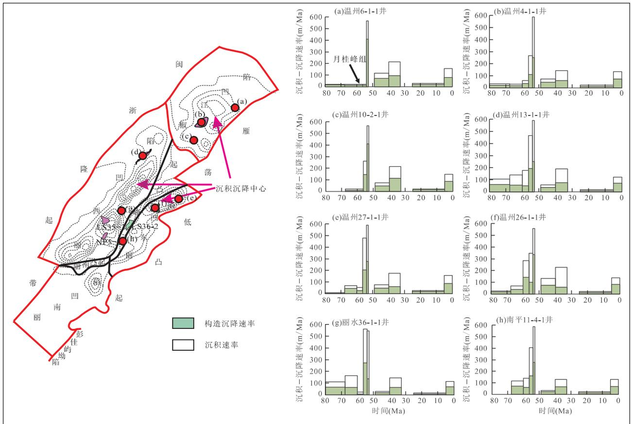
图 6 丽水—椒江凹陷沉积—沉降速率分布
